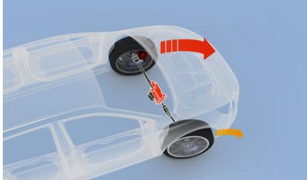
Mechaninis riboto slydimo diferencialas (m-LSD)
