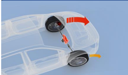
Mechaninis riboto slydimo diferencialas (m-LSD)
